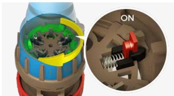
Per togliere la spina si ruota il safety ring in senso orario: l'interruttore disalimenta la presa e si estrae la spina in totale sicurezza.
