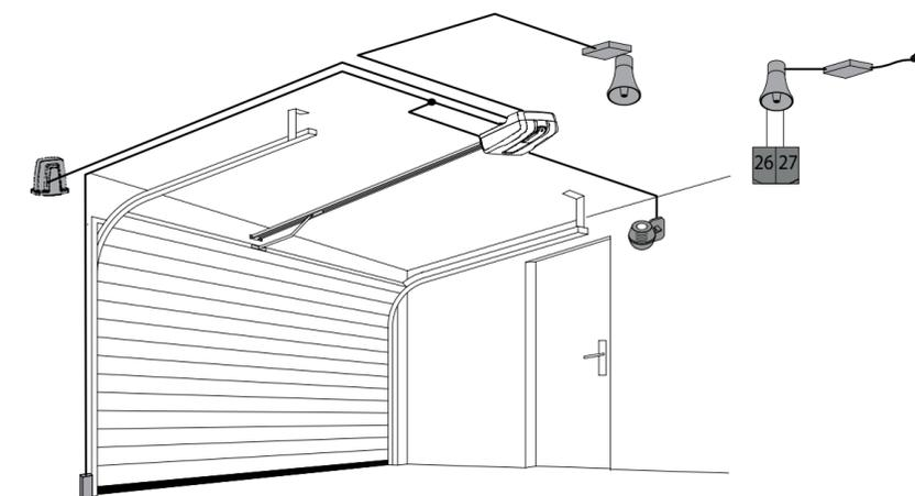
Disponibile per modelli Botticelli Smart BT A 850/1250, **consente di allarmare il garage dotandolo di un semplice sistema anti-intrusione da attivare e disattivare tramite il radiocomando Bft.** Possibilità di connettere & gestire dei sensori di presenza PIR filari + un sensore porta garage filare + una sirena filare alimentata (accessori non disponibili a catalogo Bft). Una sola unità Bft, più funzioni!
