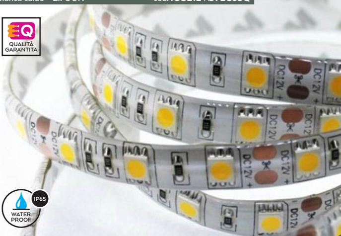
Tensione di funzionamento: 12V dc. Potenza nastro LED: 14,4 W/m. LED/m: 60 - Tipo LED: 5050. Grado di Protezione: IP65 Resina. CRI: >90. Flusso luminoso: (N) 1.195
